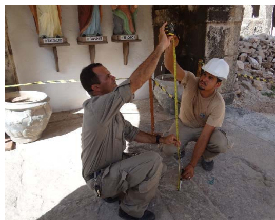
Figura 401 - Foram realizadas medições do nível do espelho d'água dentro da cacimba.
