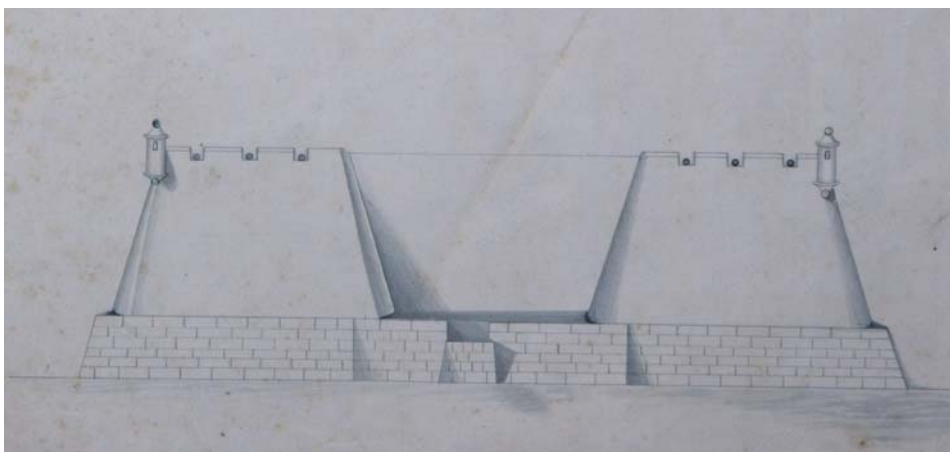
Figura 481 - Vista frontal do forte, na planta de 1873, observe-se a inclinação da muralha.
