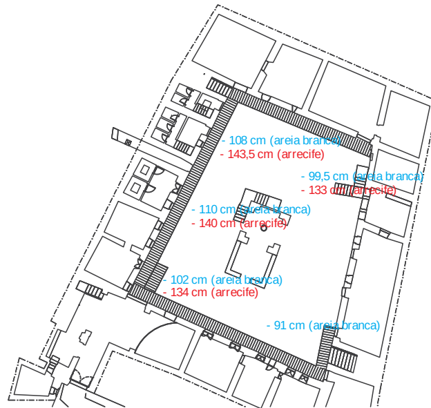
Figura 464 – desenho esquemático das cotas do arrecife (vermelho) e do aterro de areia branca (azul) na praça de armas.
